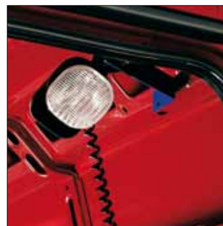
Lampada illuminazione Lampada da lavoro completa di griglia di protezione, orientabile in tutte le direzioni e fissabile alla parete del vano di carico tramite apposita staffa. Dis. 50900862
